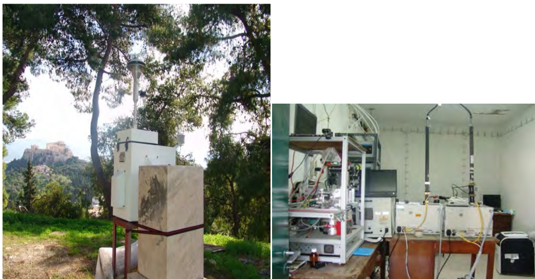
Εικόνα 2. Σταθμός μετρήσεων ποιότητας της ατμόσφαιρας του Εθνικού Αστεροσκοπείου Αθηνών στις εγκαταστάσεις στο Θησείο. Πρόκειται για το σταθμό από όπου γίνεται η παρακολούθηση του φαινομένου της αιθαλομίχλης τους τελευταίους 3 χειμώνες, με λεπτομερή χημικό και φυσικό χαρακτηρισμό της.
