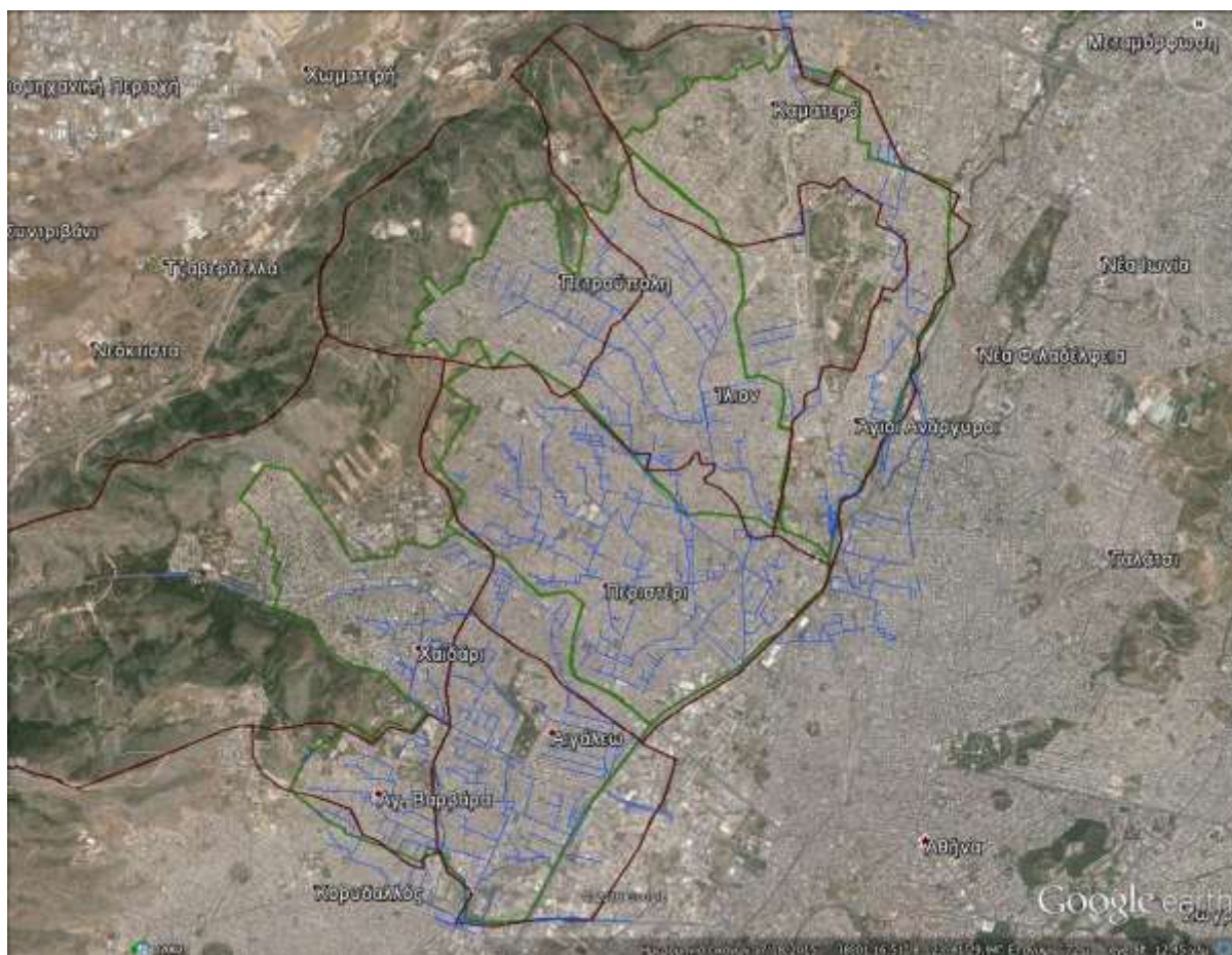
Εικόνα 1.1. Με κόκκινο χρώμα φαίνονται τα όρια των δήμων, με πράσινο χρώμα τα όρια των περιοχών μελέτης και με μπλε χρώμα οι κύριοι υφιστάμενοι αγωγοί αποχέτευσης ομβρίων.
