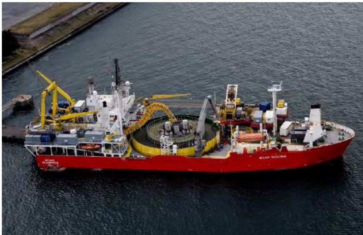
Εικόνα 3.4: Ειδικό πλοίο τοποθέτησης υποβρυχίου καλωδίου διασύνδεσης
