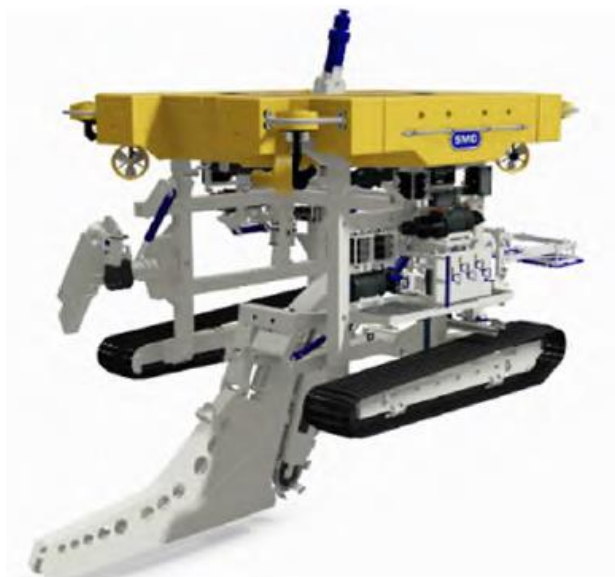
Εικόνα 3.3: Μηχάνημα τοποθέτησης υποβρυχίου καλωδίου σε βραχώδη πυθμένα
