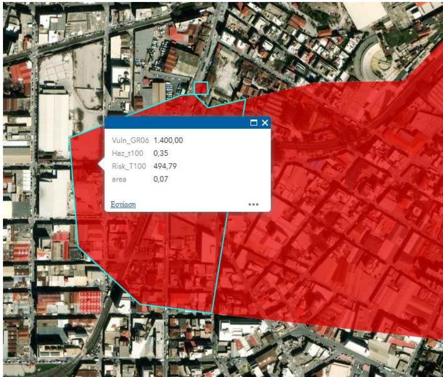
Εικόνα 9.2: Χάρτης Κινδύνου Πλημμύρας για περίοδο επαναφοράς T=100 έτη
