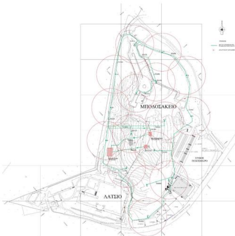
Εικόνα 3.8: Οριζοντιογραφία προτεινόμενου δικτύου πυρόσβεσης (Πηγή: μελέτη προσφοράς 2013)
