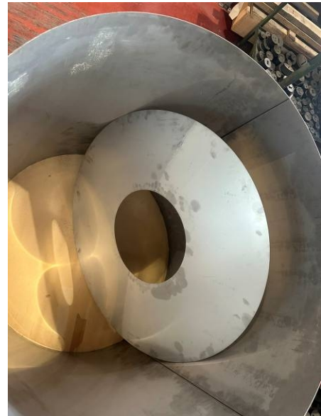
Εικόνα 3: Τμήματα του υπό κατασκευή κυκλώνα
